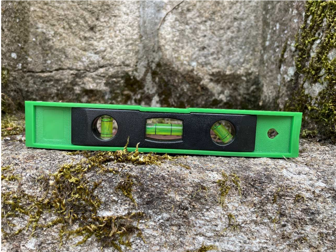
Detalle do nivel situado no pousadoiro do forno, onde se aprecia a localización da burbulla no tubo central
